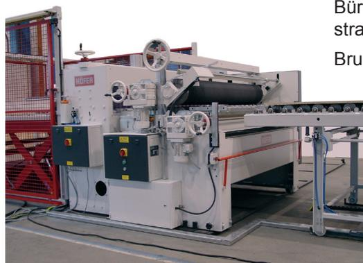
Bürstmaschine - kombiniert mit Leimauftragsmaschine in Pressenstrasse
